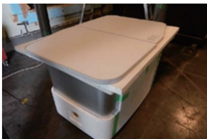
写真 1 浴槽の高断熱試験実施状況
