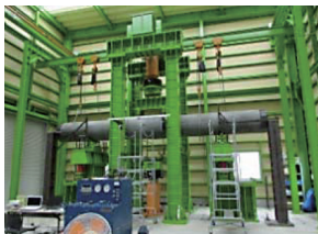
桩弯试验设备
