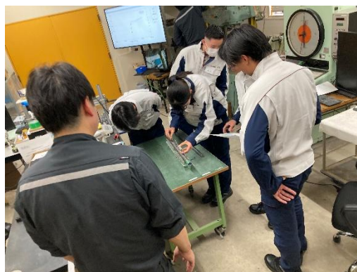
写真4 伸びの測定の様子
