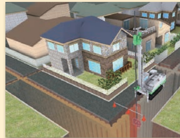
既存宅地での格子状地盤改良
