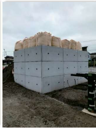
実物大の背面盛土施工試験
