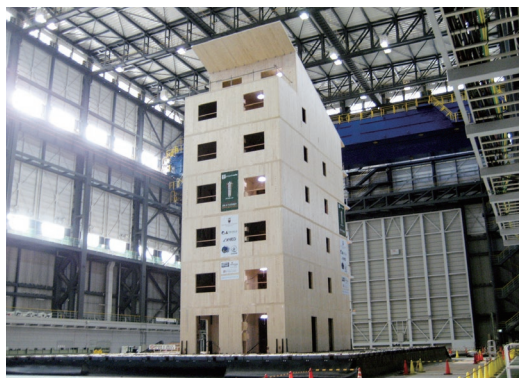
写真 3 7 階建 CLT 建築物の震動台実験
