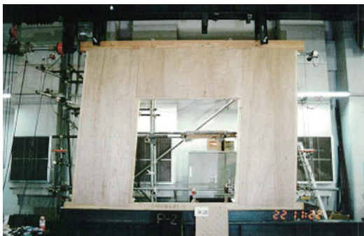
写真1 垂れ壁付合板くぎ打ち構面の水平加力実験
