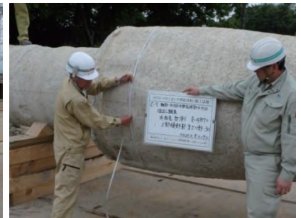
拡径部の周長計測
