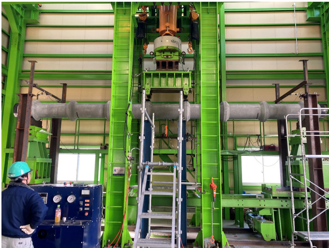
<節付きPHC杭の曲げ試験：杭強度試験棟にて>
