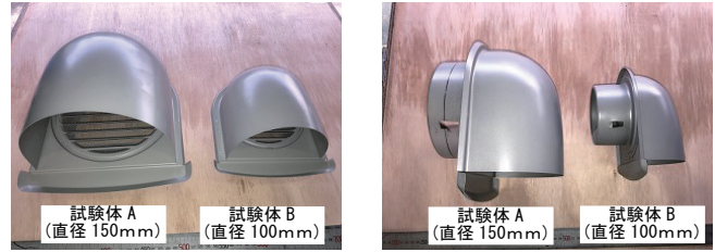
写真1 試験体（ダクト末端換気口、正面と側面）
