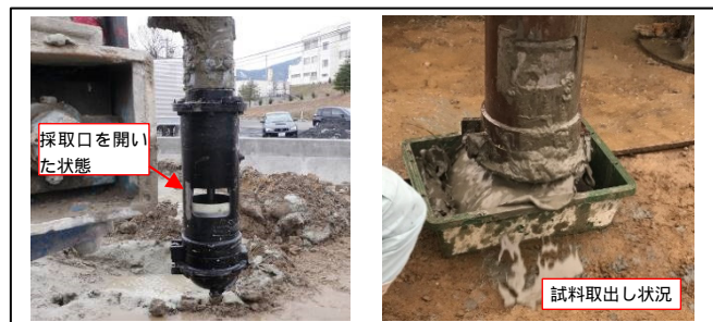
写真1 採取器（水圧式・二工程）
