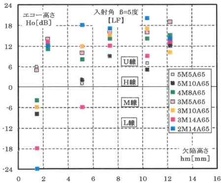
図 4.2 欠陥高さとエコー高さ ( $\beta = 5$  度)
