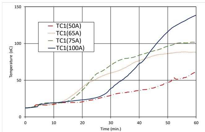
図2 VP管内部温度測定結果（壁厚100mm）
