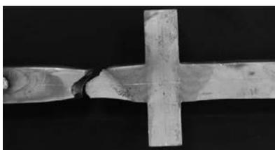
写真 5 コラム HAZ - 母材破断
