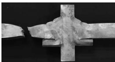
写真 4 コラム母材破断
