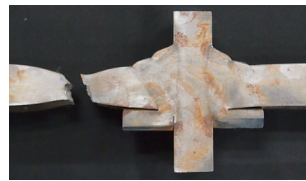
コラム母材破断 写真2 破断モード T1
