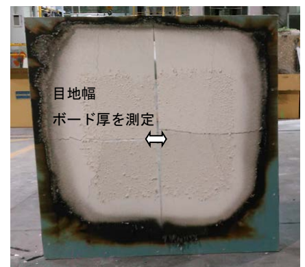
写真1 加熱後状況(試験体①加熱面)
