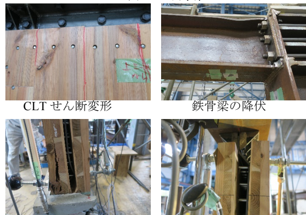
CLT 圧壊・鋼板の座屈 CLT スリットの開き 図3 破壊性状(S60-DP-C1)
