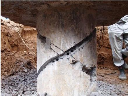
写真 1 はつり後の杭頭部の状況 (試験体 No.3)
