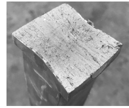
(a) 中板破断 (板厚中心)
