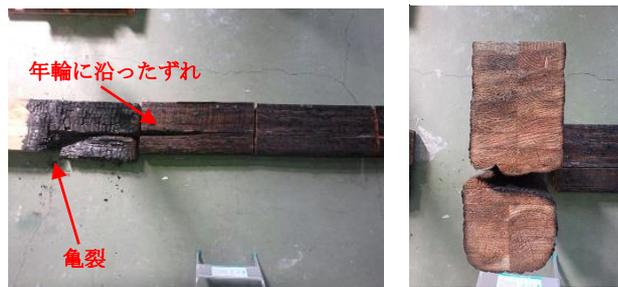
写真2 試験体①の破壊状況
