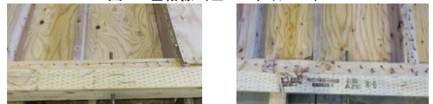
図5. 解体時の試験体 (左: A4、右: B4)
