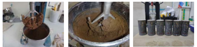
写真 1 ローム試料の混練・供試体の状況
