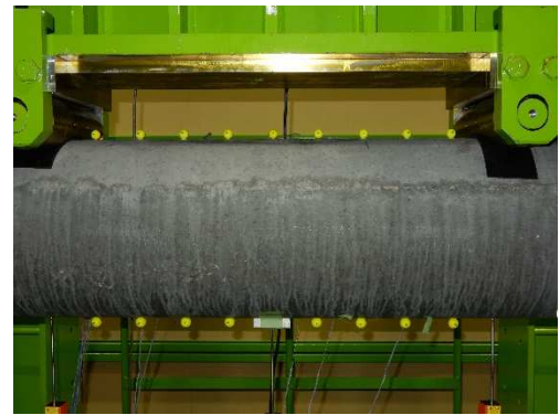
写真-1 ターゲット計測状況
