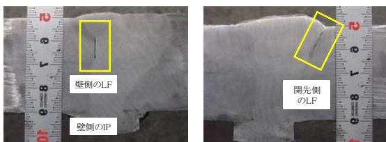
図 2.2 マクロ試験による欠陥断面
