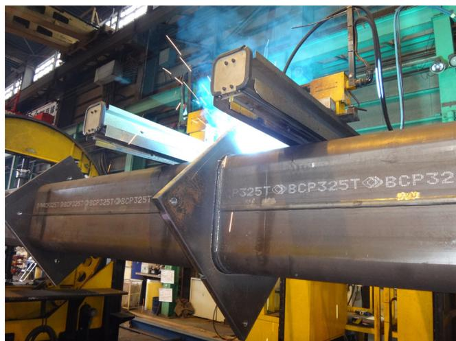
写真1 単関節溶接ロボットによる試験体製作状況
