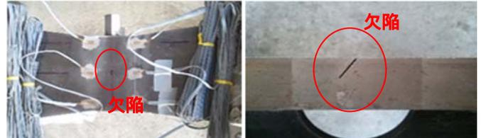
写真 1 欠陥挿入状況
