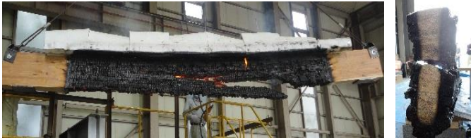
図 4(a) 試験体 No. 6 の破壊状況
