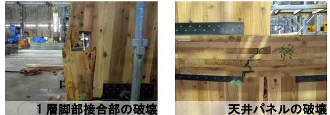
写真1 2層実験特有の破壊性状
