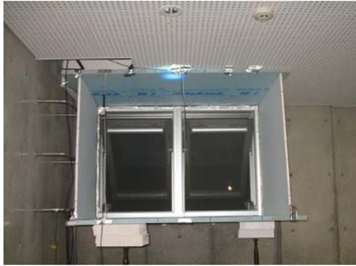
写真2 通風量測定状況
