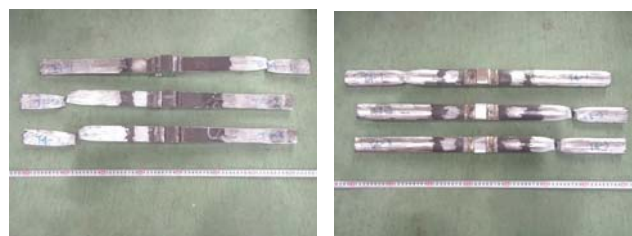
写真1 破壊性状(十字引張試験)
