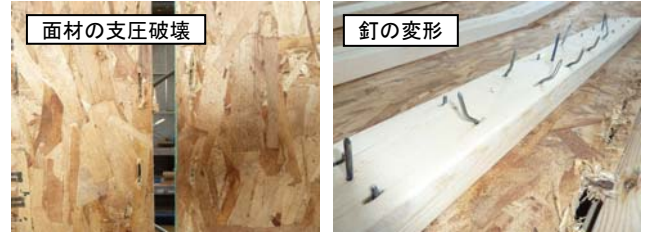
写真 1 MP 耐力壁の面内せん断試験時の破壊状況
