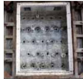
図 5 壁用耐火試験炉 写真(ベターリビング)
