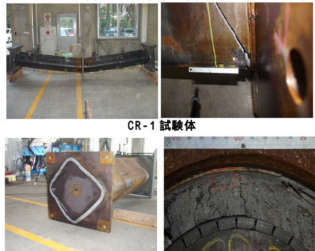
CP-4 試験体 写真1 破断状況
