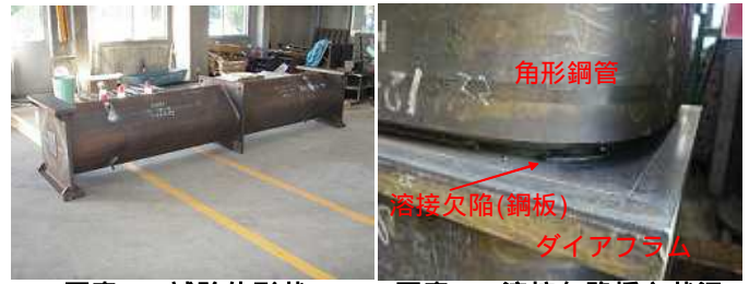
写真1 試験体形状 写真2 溶接欠陥挿入状況
