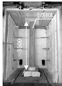
写真 4-1 加熱前試験体の様子
