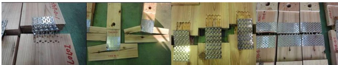
写真1 破壊状況(左から、引き抜け、割裂、木材破壊、プレート破断)
