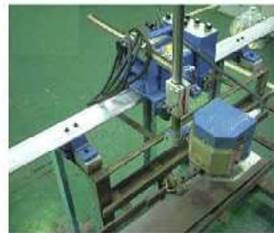
写真 1 本実験で使用した自動溶接機
