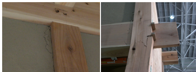
写真 1 今年度(135mm 角)の破壊性状
