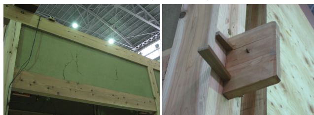
写真 2 昨年度(150mm 角)の破壊性状
