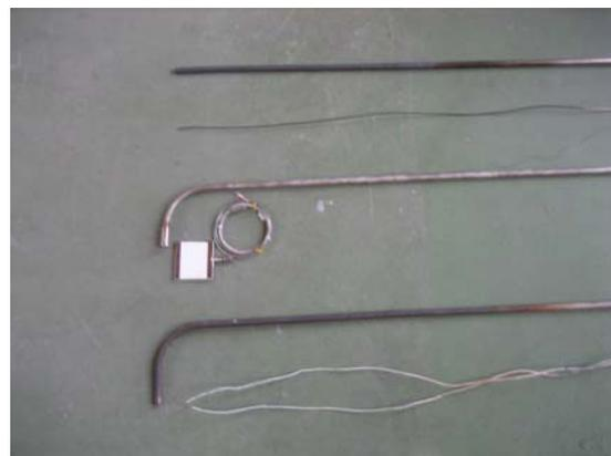
写真1 加熱側熱電対(上から日本,ISO,ASTM 方式)
