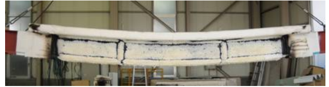
写真 1 荷重加熱後試験体 (H400 梁)
