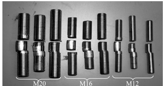
写真1 せん断実験後の破断状況の例
