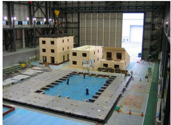
写真 2 震動台への試験体吊り込み準備
