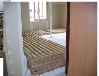
写真2 火災室可燃物配置状況
