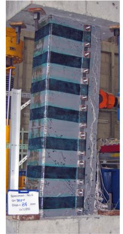
写真3 破壊状況 (+1/25rad.)
