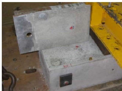
図5 実験後の供試体（溶接タイプ）
