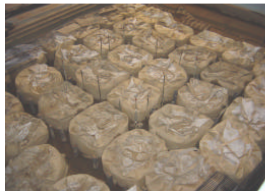
写-2 軟弱地盤実験での載荷状態
