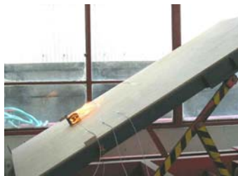
写真2 試験実施状況 (30度)
