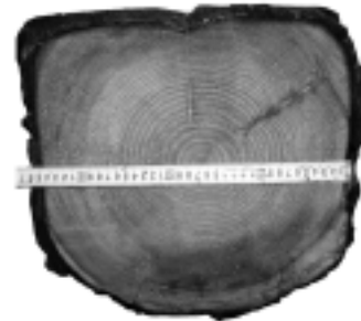
写真 - 2 試験体記号 SL-S40 (スギ) の試験後 の断面形状
