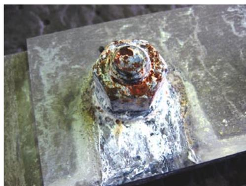
写真 1 ボルトの発錆状況 (2500 時間)
