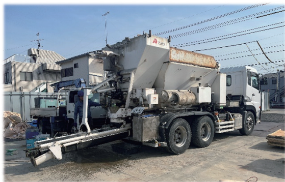
①材料攪拌（左：連続式モバイルコンクリートミキサー、右：バッチ式ミキサー）
