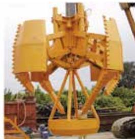
TMB掘削バケット(中間拡径部)
